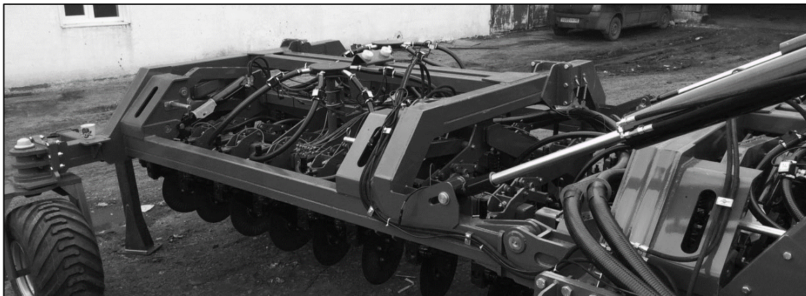
Рисунок 50 – Гидроцилиндры складывания боковых секций
