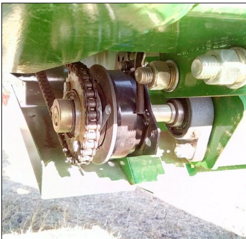
Рисунок 54 – Электромагнитная муфта привода
